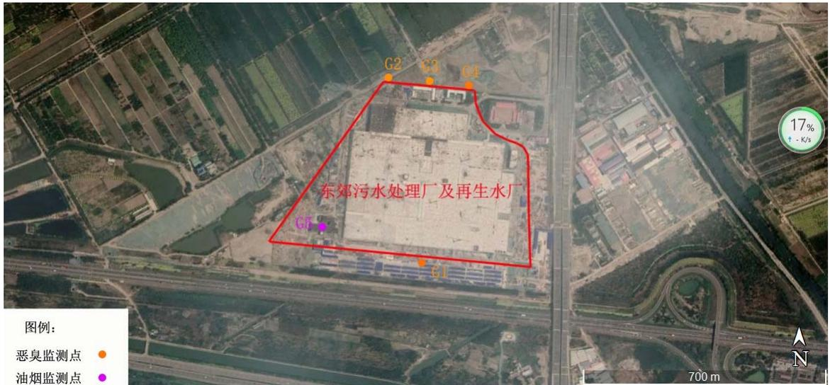
图 7.2-1 废气监测点位示意图
